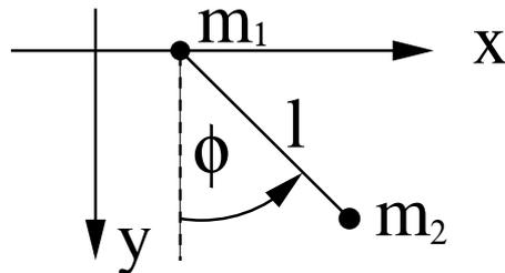
Eine Hantel bestehe aus den beiden Massen  $m_1$  und  $m_2$  im Abstand  $l$ . Die Masse  $m_1$  der Hantel kann sich reibungsfrei entlang einer horizontalen Geraden bewegen. Auf beide Massen wirke die Schwerkraft in  $y$ -Richtung.
