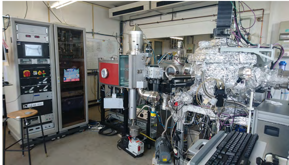
Kombinierte Sputter- und Molekularstrahlanlage der Arbeitsgruppe Reiss: mit dieser Anlage können dünne Schichten aus verschiedenen Materialien atomlagen genau hergestellt werden.
